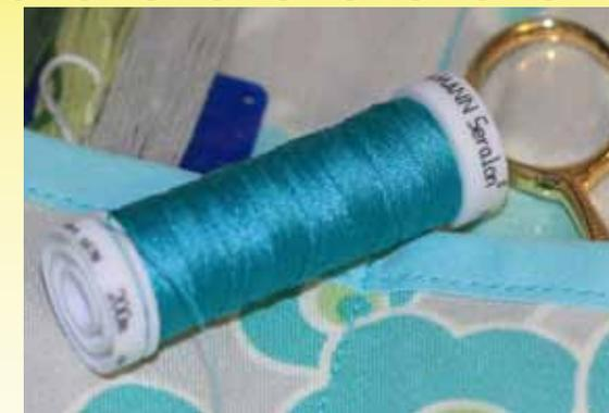
**Метрическая нумерация обозначается символом «Nm».** Этот способ нумерации показывает, **сколько метров нити весит 1 грамм.** Например: Nm 120/1 - обозначает, что 120 м весят 1 г.
